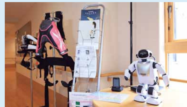
腰に装着し、移乗介助などの動作をサポートする介護ロボットは、職員の仕事にかかる負担を軽減。腰痛のリスクを減らし、安全に介助を行うことができます
